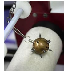
スナッグ試験 一般財団法人カケンテストセンターより参照
