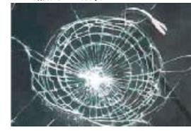
ガラスが割れても飛び散りにくい「飛散防止効果」のあるフィルムを貼っています。
